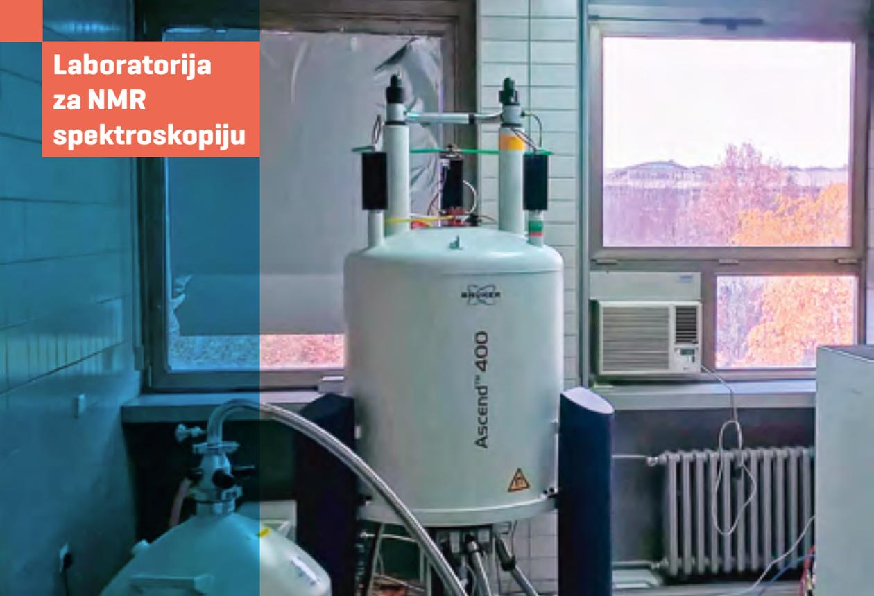
Na Departmanu za hemiju, biohemiju i zaštitu životne sredine Prirodno-matematičkog fakulteta u Novom Sadu laboratorija za NMR spektroskopiju postoji preko 25 godina, 2014. godine instaliran je novi NMR spektrometar visoke rezolucije [radna frekvencija 400 MHz; proizvođač Bruker, Nemačka]. Pomoću navedene opreme moguće je izvršiti kvalitativnu i kvantitativnu analizu širokog opsega organskih supstanci kao što su petrohemijske, prirodni proizvodi, fine hemikalije [farmaceutici] itd.
